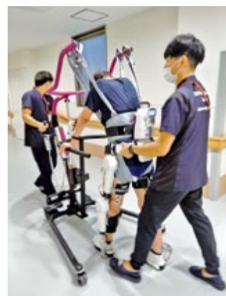
ロボットリハビリテーション (HAL：hybrid assistive limb) による歩行訓練
